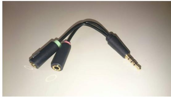
図 2-8 マイク/ヘッドフォン共用端子へのマイク接続用変換ケーブル
